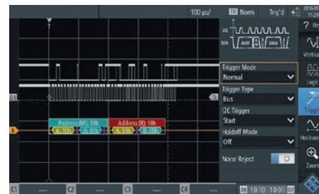
Рис. 6. Прибор R&S Scope Rider — первый портативный осциллограф с цифровым логическим интерфейсом (осциллограф смешанных сигналов); его можно использовать даже для запуска и декодирования последовательных протоколов. Источник: Rohde & Schwarz
