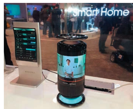
Рис. 51. Цилиндрический динамик с гибким сенсорным дисплеем Mirage Smart Speaker от компании Royole
